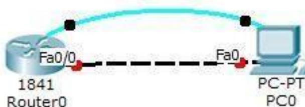
Рисунок 3.9 – Топология с использованием двух типов кабелей
