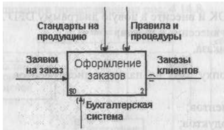
Рис. 4.15.3. Работа "Оформление заказов" на диаграмме A2
