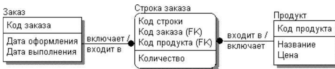
Рисунок 8. Автоматически созданная физическая схема БД
