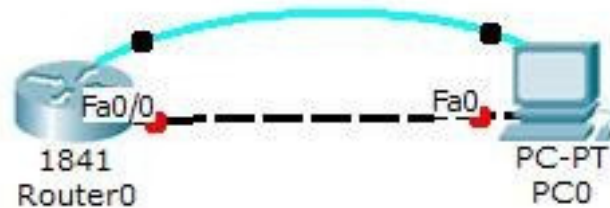
Рисунок 3.9 – Топология с использованием двух типов кабелей
