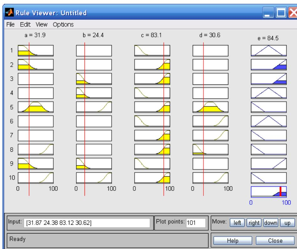
Рисунок 8 – Окно редактора вывода (входы 32, 24, 83, 31, результат – прогнозируемые затраты на ремонт -
