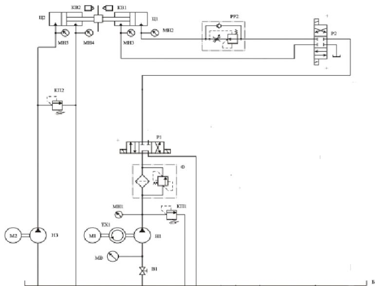
Рисунок 7.4. Схема гидравлическая для исследования характеристик объёмного гидропривода.
