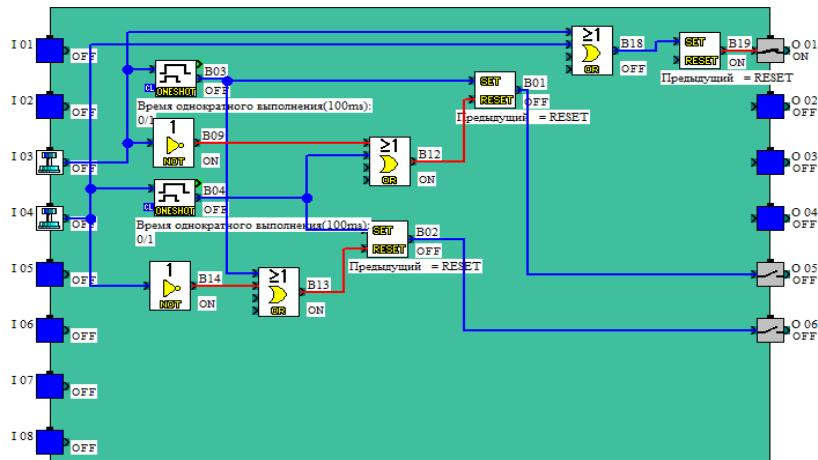
Рисунок 10.5. Реакция ПЛК на изменение состояния входа *in3*
