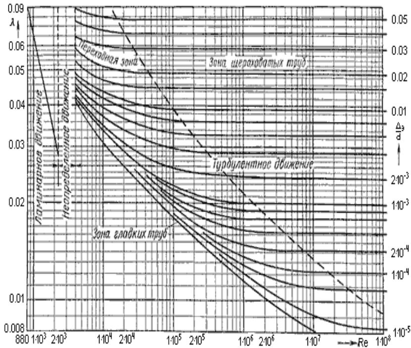
Рисунок 4.4. Номограмма Кольброка-Уайта для определения коэффициента гидравлического трения.
