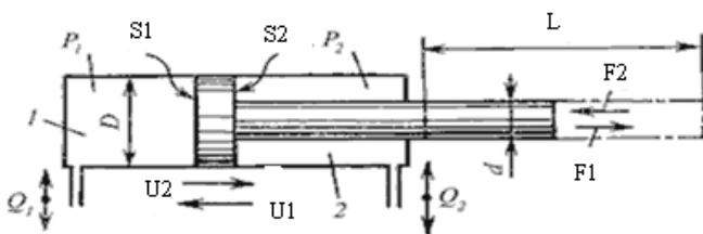
Рисунок 7.3. Основные и расчетные параметры гидроцилиндра
