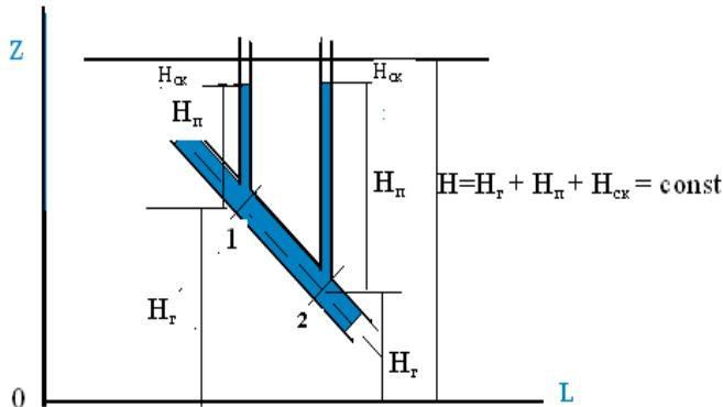
Рисунок 2.2. Графическая интерпретация уравнения Бернулли для идеальной жидкости
