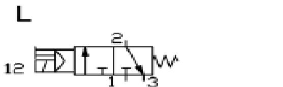
Рисунок 9.6. Пневмораспределитель 3/2 (P1)
