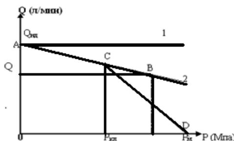
Рисунок 6.3. Графическая зависимость подачи от давления насоса.
