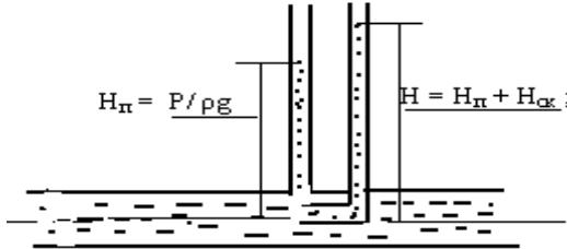
Рисунок 2.1. Измерение скоростного напора
