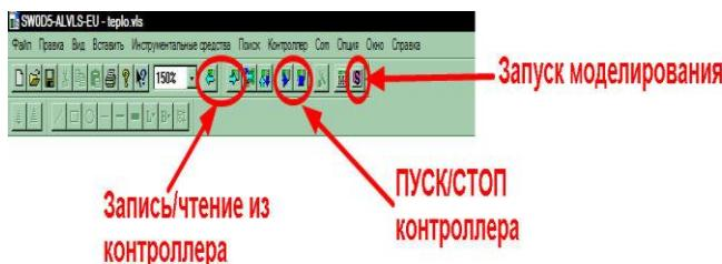
Рисунок 10.1 – Панель инструментов интерфейса программы Mitsubishi Alpha Programming
