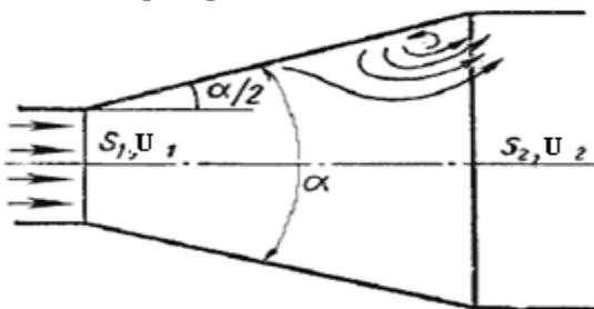
Рисунок 3.2. Диффузор
