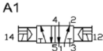
Рисунок 9.7. Пневмораспределитель 5/2 (P2)
