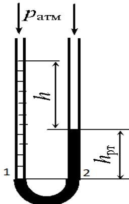
Из закона Паскаля следует, что в точках 1 и 2 давления одинаковы. Свойства гидростатического давления таковы, что в т. 1 и 2 давления сверху и снизу одинаковы. Отсюда следует, что в т. 1 избыточное давление сверху равно весовому давлению столба воды  $h_{\text{в}}$ . Пусть высота столба воды  $h_{\text{в}}$ . Давление сверху:  $P_1 = P_{\text{атм}} + \rho_{\text{в}} \cdot g \cdot h_{\text{в}}$ . (6-1) Избыточное давление снизу в т. 1 равно весовому давлению столба ртути в точке 2
