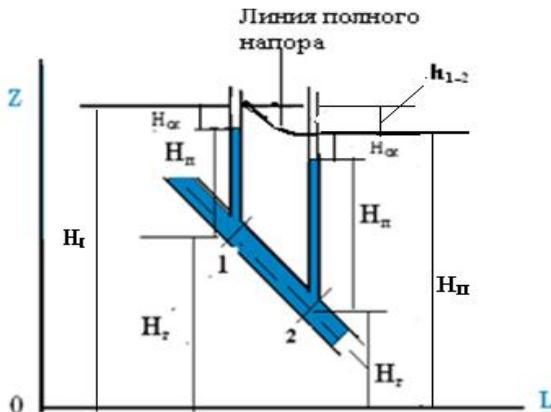
Рисунок 2.3 Графическая интерпретация уравнения Бернулли для реальной жидкости
