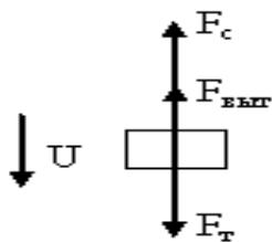
Рисунок к задаче 3. Схема сил, действующих на тело, падающее равномерно (с постоянной скоростью) в жидкости.
