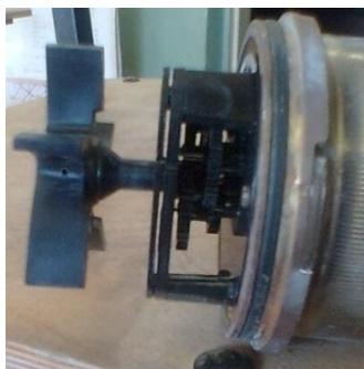
Рисунок 1.4.Крыльчатый расходомер
