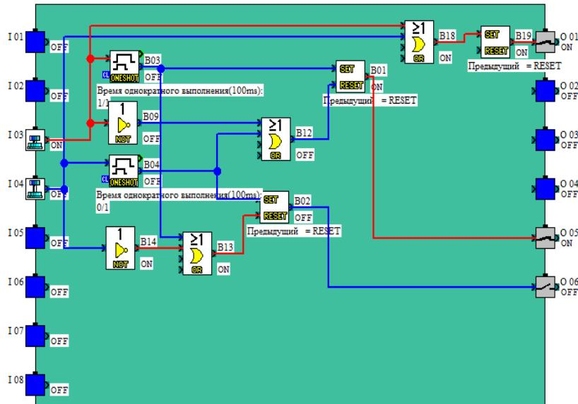
Рисунок 10.4. Реакция ПЛК на изменение состояния входа *in3*
