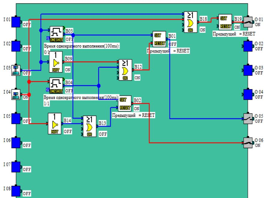
Рисунок 10.6. Реакция ПЛК на изменение состояния входа in4
