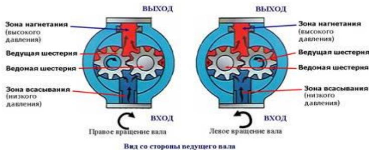
Рисунок 6. 1. Устройство шестерённого насоса с внешним зацеплением зубьев.
