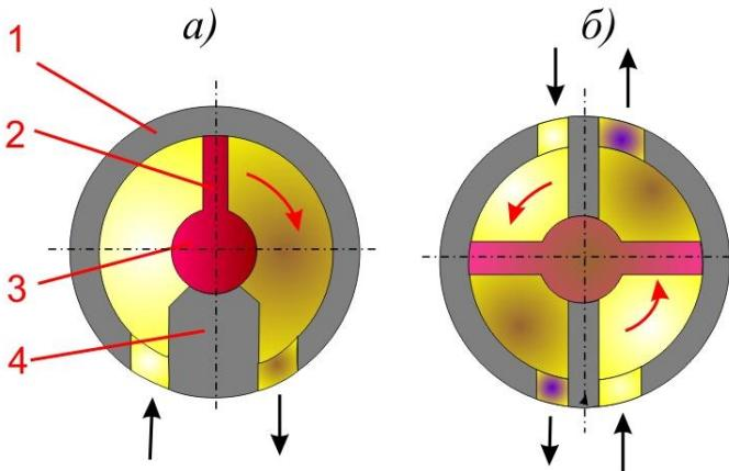
Рисунок к задаче 19. Шиберные (поворотные) гидродвигатели:
