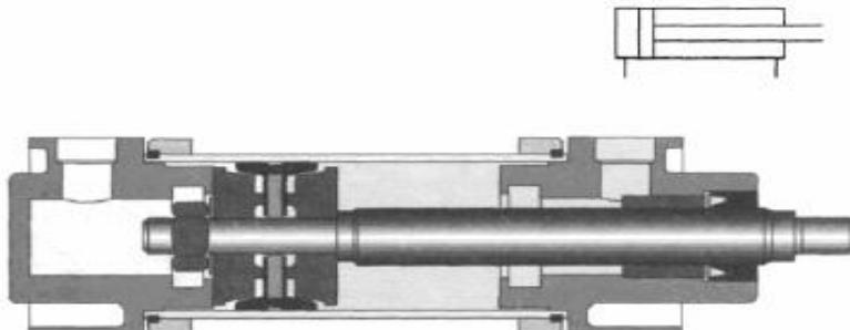
Рисунок 9.14. Пневмоцилиндр двустороннего действия.
