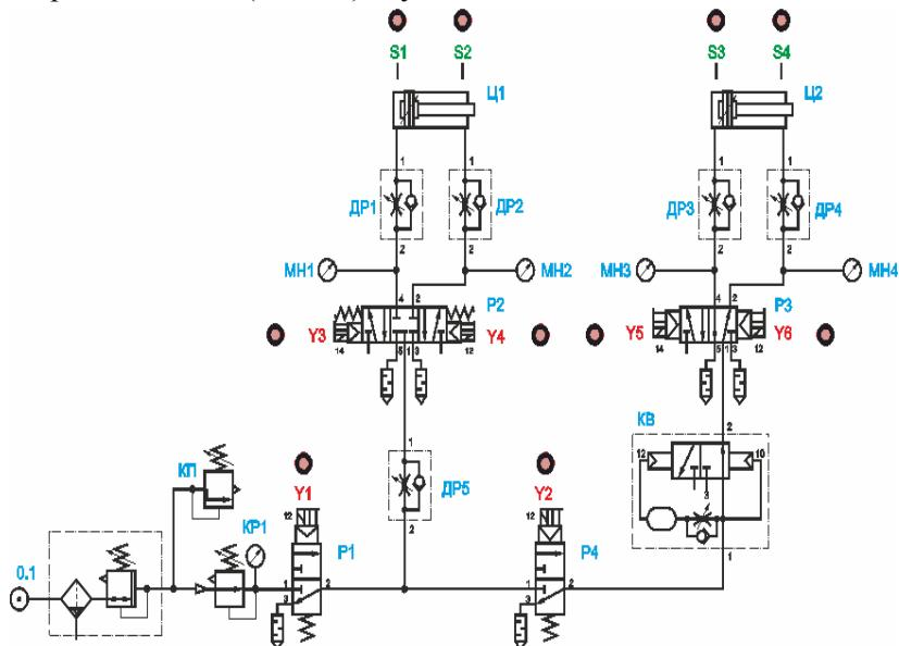
Рисунок 9.3. Схема пневмоустановки.
