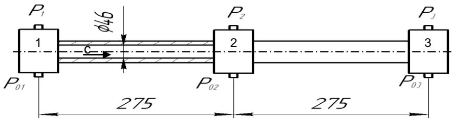
Рисунок 5.3. Схема продувочного модуля (трубы) с тремя сечениями.
