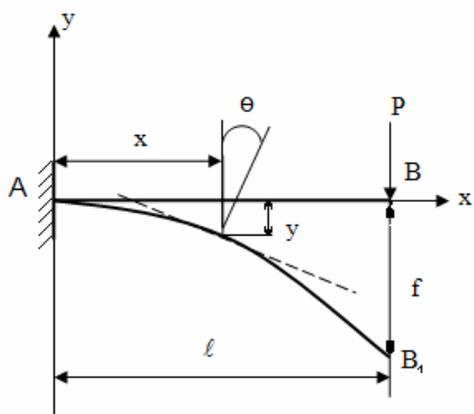
Дан прямой стержень. Его ось до деформации занимает положение  $OB$ . После деформации ось стержня искривится и займет положение  $AA_1B'_1$ . Изогнутая ось балки (стержня) называют упругой линией.
