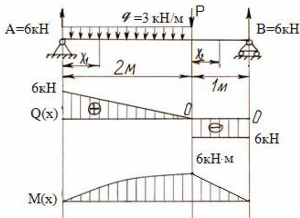
Изгибающий момент  $M$ , в каком-либо сечении стержня равен алгебраической сумме моментов относительно центра тяжести сечения
