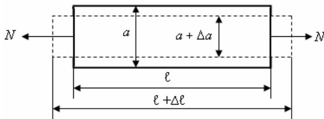
Здесь  $E$  коэффициент пропорциональности, называемый модулем упругости при растяжении (модуль упругости первого рода), имеет размерность напряжений:  $\text{кг/см}^2$ ;  $\text{кг/мм}^2$ ;  $\text{Н/м}^2$ ;  $\text{МН/м}^2$  (Па).
