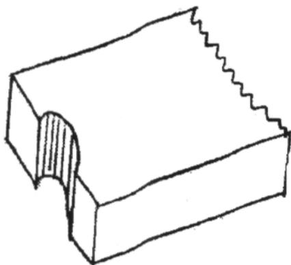
Однако, так как нормальные напряжения в них значительно меньше касательных, то в приближенных расчетах учитывают лишь касательные напряжения, а указанные сечения при этом рассматривают как площадки сдвига. Такие расчеты называются расчетами на сдвиг или на срез, или на скалывание.
