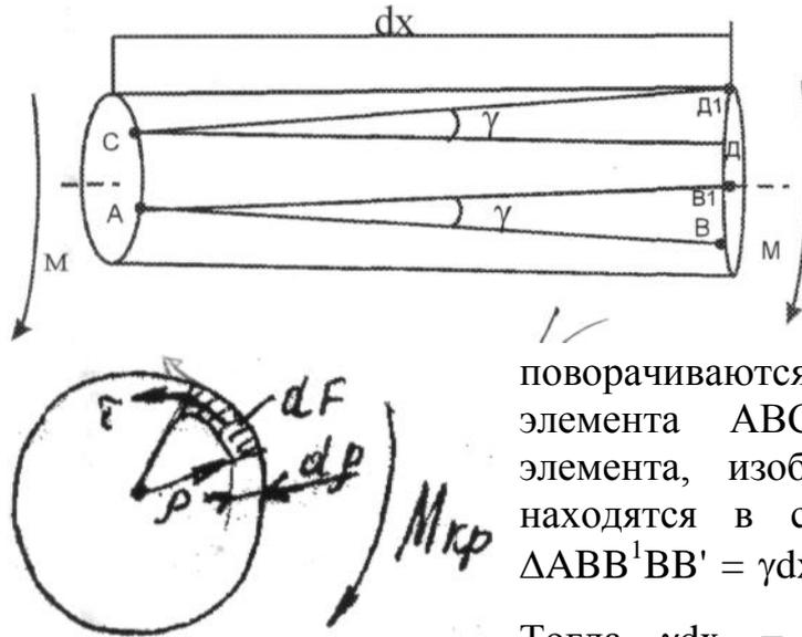
Выделим из бруса элемент длиной  $dx$ . Правое торцевое сечение кольца поворачивается при кручении относительно левого на угол  $d\varphi$ . При этом образующие цилиндра  $CD$  и  $AB$
