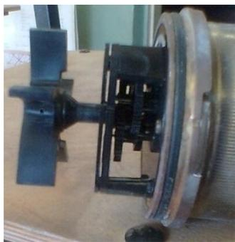
Рисунок 1.4. Крыльчатый расходомер
