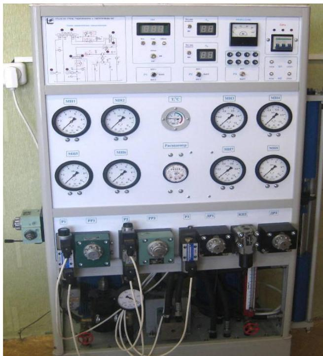
Рисунок 6.4. Общий вид стенда 36.100 «Гидравлические машины и гидроприводы»
