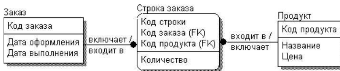
Рисунок 8. Автоматически созданная физическая схема БД
