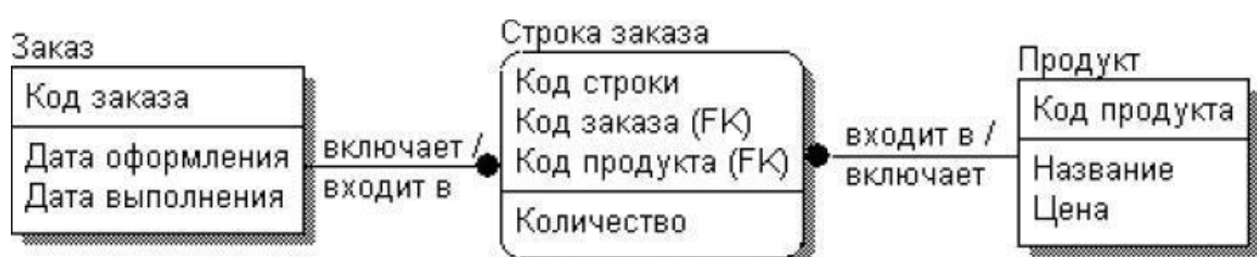
Рисунок 7.Пример логической схемы БД
