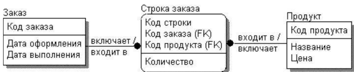
Рисунок 7.Пример логической схемы БД
