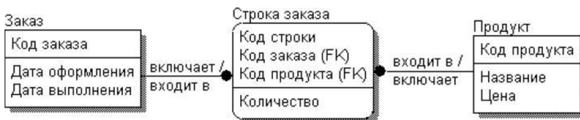
Рисунок 7.Пример логической схемы БД
