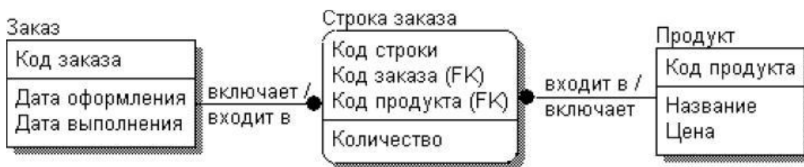
Рисунок 8.Автоматически созданная физическая схема БД
