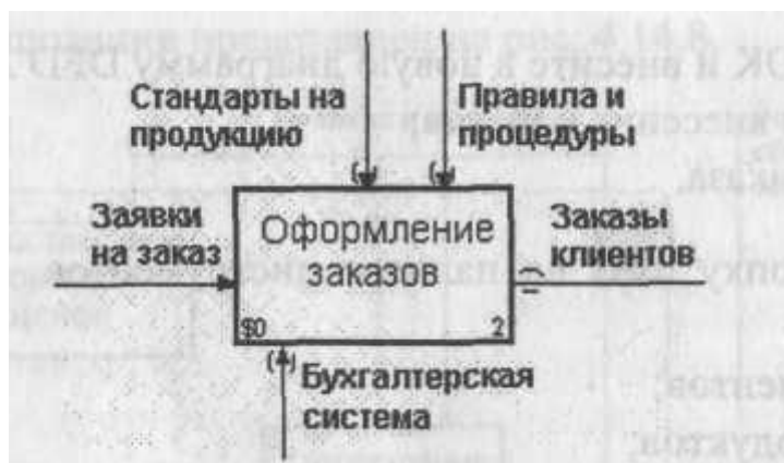
Рис. 4.15.3. Работа "Оформление заказов" на диаграмме A2
