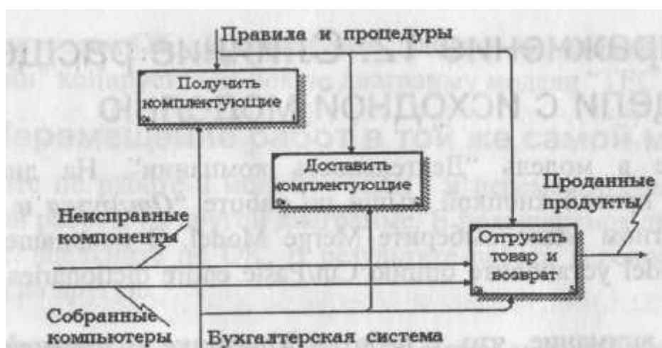
Рис. 4.11.1. Внутренние стрелки на декомпозиции работы "Отгрузка и получение"
