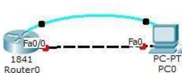
Рисунок 3.9 – Топология с использованием двух типов кабелей
