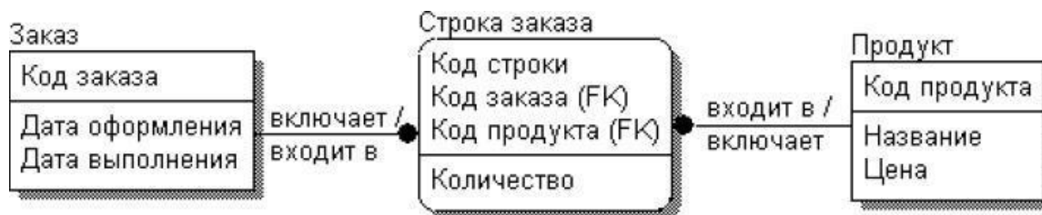
Рисунок 8. Автоматически созданная физическая схема БД
