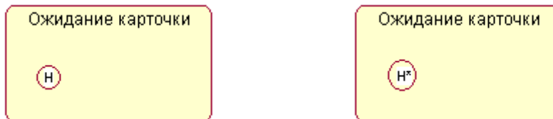
Рис. 9.3. Добавление вложенного исторического состояния (а) и состояния глубокой истории (б) для состояния Ожидание карточки
