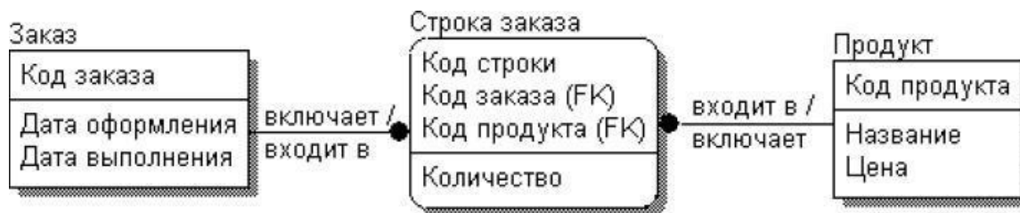
Рисунок 8. Автоматически созданная физическая схема БД
