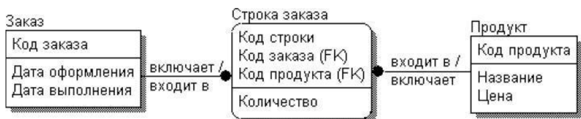
Рисунок 7.Пример логической схемы БД
