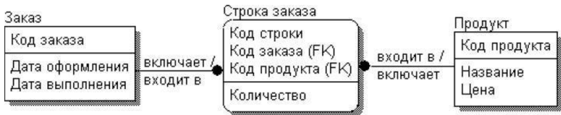
Рисунок 8. Автоматически созданная физическая схема БД
