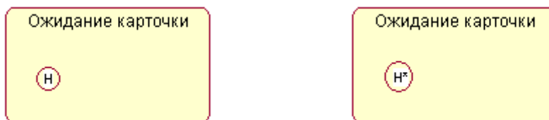
Рис. 9.3. Добавление вложенного исторического состояния (а) и состояния глубокой истории (б) для состояния Ожидание карточки
