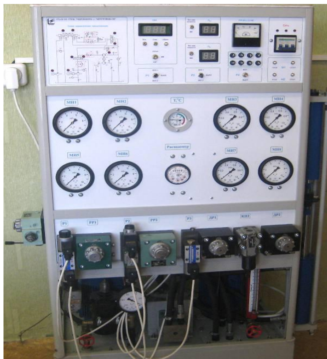
Рисунок 6.4. Общий вид стенда 36.100 «Гидравлические машины и гидроприводы»
